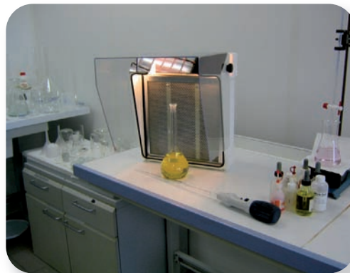
Hotte valise HI3P Facilement déplaçable Eclairage incorporé Importante surface d'aspiration
