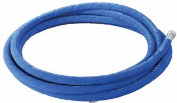
Tuyau antistatique en caoutchouc EPDM avec renfort textile extérieur. Idéal pour l'usage dans la cabine. Léger, flexible et maniable. Pas de torsion. Résistant aux très hautes températures. Conduction du tuyau < 1 M Ω
