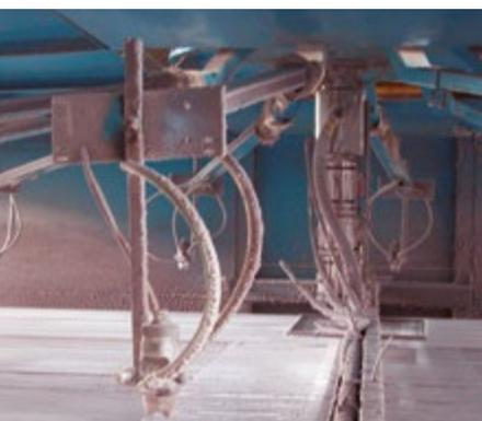
Pistolet Conventionnel, idéal pour les robots et les machines spéciales.
