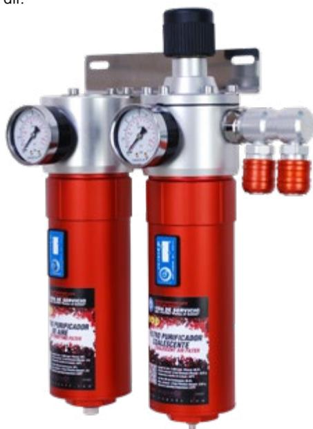
Le modèle 5200X offre la plus haute technologie pour la filtration d'air. Il intègre un filtre en bronze fritté de 8 microns, suivi par une filtration finale grâce à un filtre coalescent de 0,01 micron.
