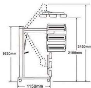
Le plus grand et le plus puissant de nos sècheurs à infrarouges. Grâce à ses 3 lampes de 1100 W chacune, le KR 300AX permet le séchage de tout un toit ou 2 portes simultanément.
